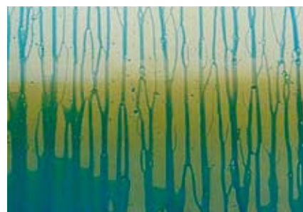
Tejido de alto módulo sin tratamiento especial: humectabilidad irregular
