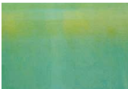
SEFAR® PET 1500 – humectabilidad uniforme: En una prueba con agua teñida se ve claramente el comportamiento divergente de la humectabilidad
